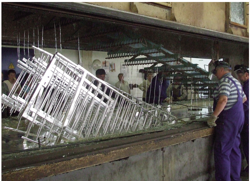
Arbeiter bei der Entnahme der zu verzinkenden Bauteile aus dem Zinkbad
